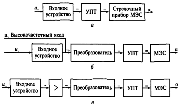
Рис. 14.10. Структурная схема аналоговых электронных вольтметров: а — постоянного тока; б — напряжений большого уровня; в — милливольтметра; УПТ — усилитель постоянного тока; > — усилитель переменного тока; МЭС — магнитно-электрическая схема
