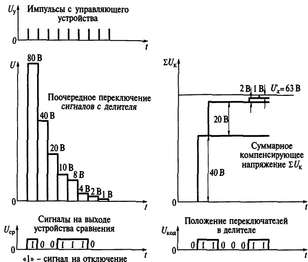
Рис. 14.18. Графики, показывающие работу кодово-импульсного вольтметра
