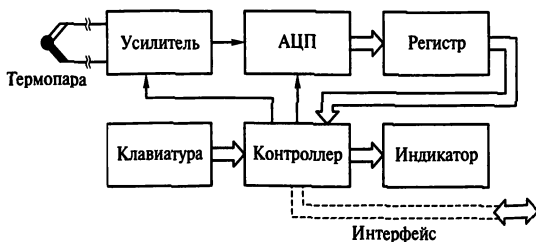
Рис. 11.10. Структура контактного цифрового термометра
