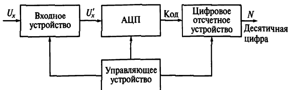
Рис. 14.15. Упрощенная структурная схема цифрового вольтметра
