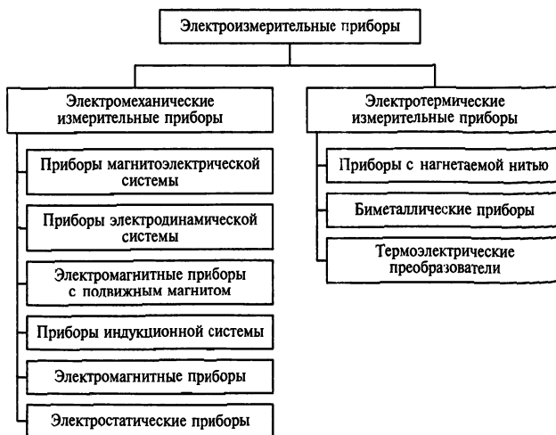
Рис. 12.1. Классификация электроизмерительных приборов
